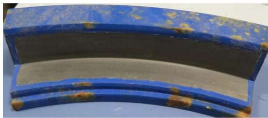
Рисунок 9. Общий образец с цинковым гальваническим покрытием: а) исходное состояние образца; б) состояние образца после выдержки в камере влажности в течение 650 ч
