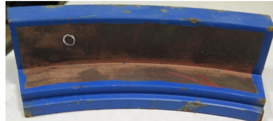
Рисунок 10. Общий образец с газотермическим покрытием (алюминий-хром-никель):
