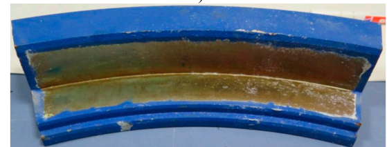
Рисунок 11. Общий образец с лазерно-плазменным покрытием (медь):
