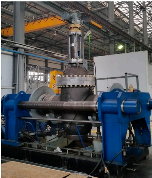
Рисунок 8. Общий вид задвижки шиберной DN 500 PN 8,0 МПа
